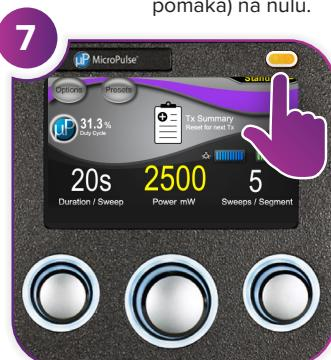
Pritisnite taj gumb za ulazak u način rada Treat (Tretman) (omogućavanje lasera).
